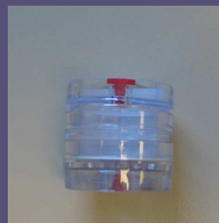
Cassette porte-filtre Diam. 37 mm + filtre en fibre de quartz
